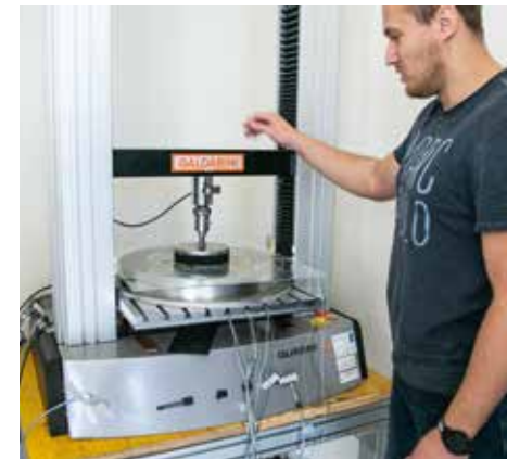
Biegen mit konstantem Biegeradius
