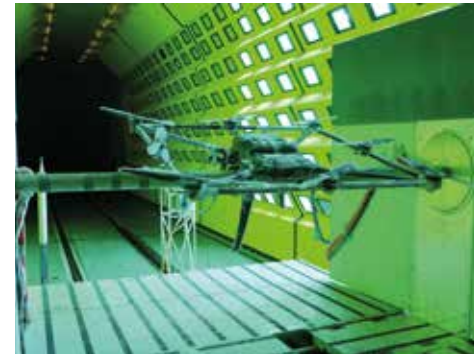
Die Octocopterdrohne der FH JOANNEUM wurde unter anderem bei Minusgraden, einer Windstärke von knapp 80 km/h sowie typischen Vereisungssituationen der bemannten Luftfahrt getestet. Foto: Rail Tec Arsenal.
